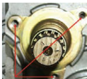
Les 3 mêmes points de montage pour le tube-guide
